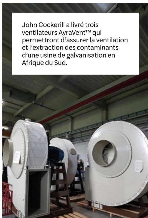
John Cockerill a livré trois ventilateurs AyraVent™ qui permettront d'assurer la ventilation et l'extraction des contaminants d'une usine de galvanisation en Afrique du Sud.
