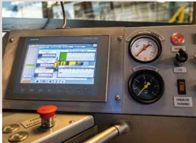
Панель управления с сенсорными экранами (скорость, сила тяги, расход, параметры двигателя, ...)
