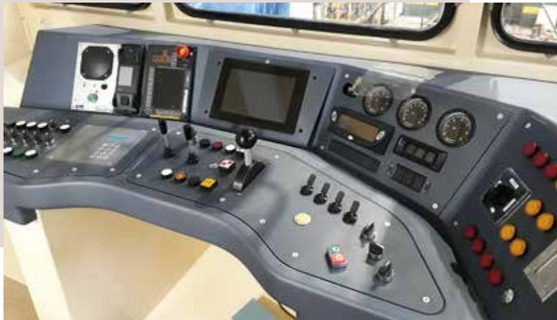
Panneau de contrôle (un tableau de bord par cabine)
