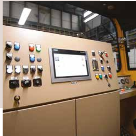
Poste de conduite ergonomique avec commande traction/freinage par joystick
