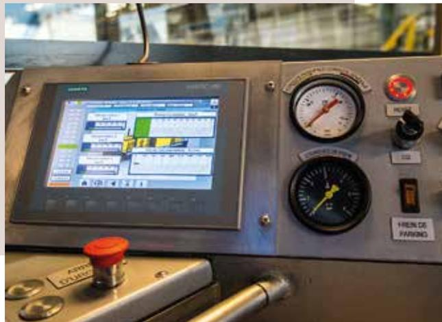
Pupitre équipé d'écrans tactiles (vitesse, force de traction, consommation, paramètres moteur, ...)
