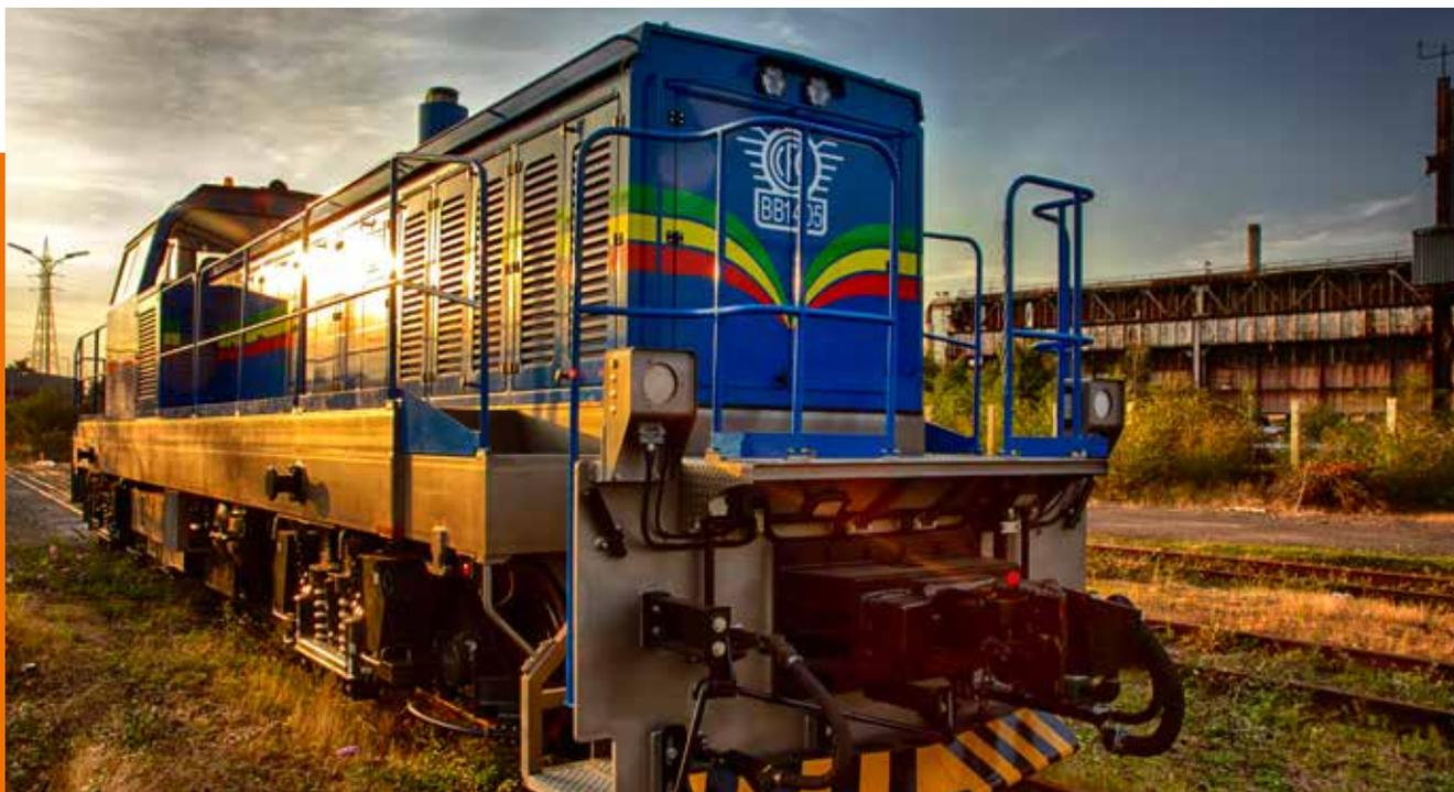
Avec 1200CV et une transmission AC/AC de haut rendement, la locomotive est adaptée à tous les besoins de traction. Peut convenir également pour tracter des trains de voyageurs sur de longues distances. La DE1200 peut également être utilisée en unités multiples (double traction) ce qui permet de tirer le train marchandise de plus de 10.000T. Cela fait de ce modèle un incontournable dans votre flotte.
